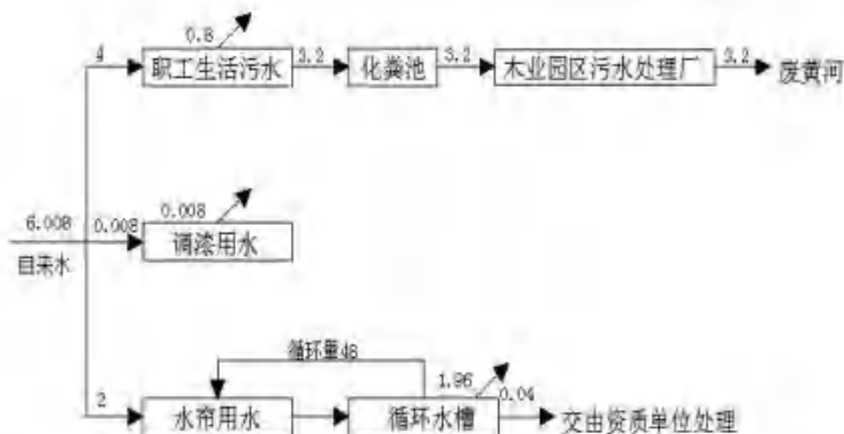
图六 项目水量平衡图 (m³/d)
