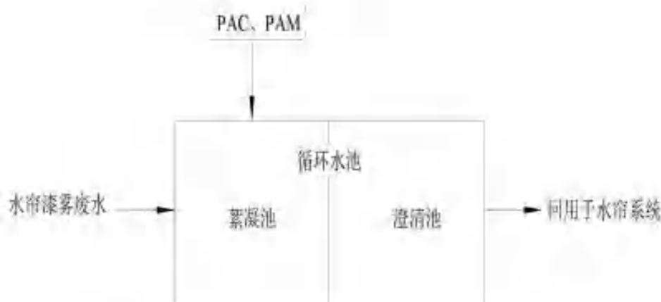
图五 水帘漆雾废水和洗涤塔废水处理工艺
