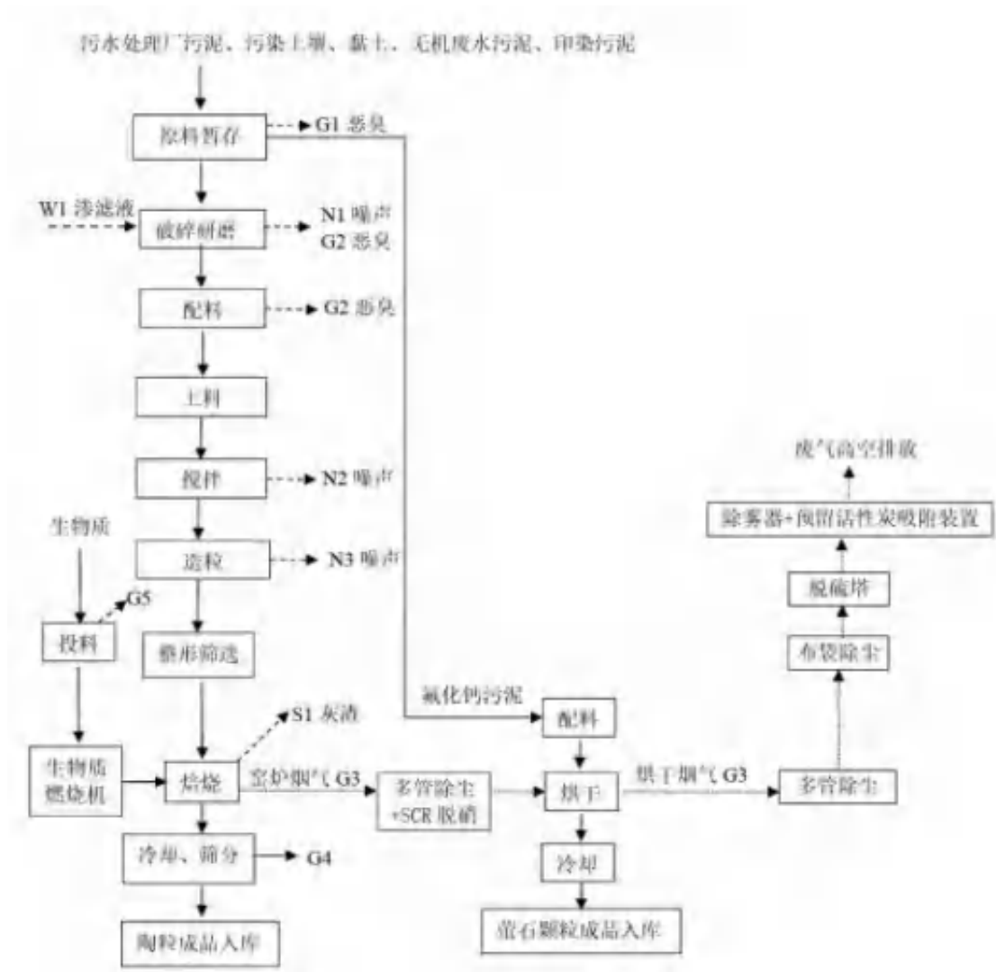
图 5-1 陶粒、萤石颗粒生产工艺流程及产污环节图（萤石颗粒生产线未投产，不纳入本次验收） 环评中设计本项目有两种产品：陶粒和萤石颗粒，陶粒焙烧回转窑产生的烟气经过多管除尘预处理后通入萤石颗粒烘干机作为直接烘干热源，通过烘干机出口排放。实际已建设 1 条陶粒生产线和 1 条萤石颗粒生产线，因萤石颗粒生产线短时间内不会投入运行，不在本次验收范围内。
