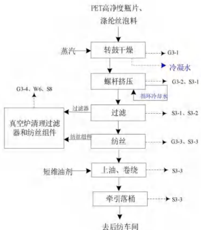
图 3.5-4 前纺生产工艺及产污流程图
